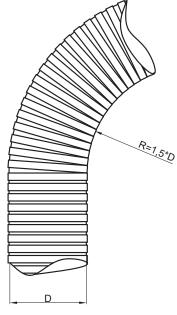
rys.1. Bending radius
